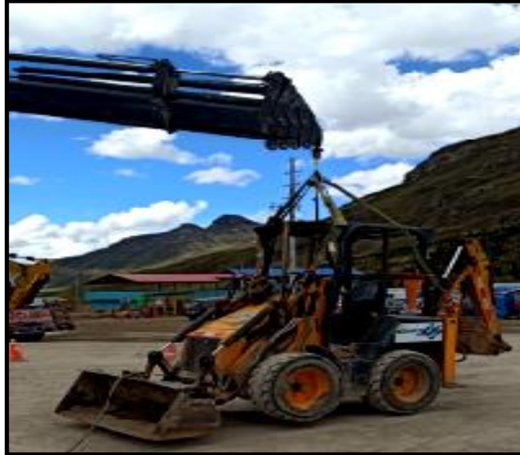
GRÚA DE BRAZO ARTICULADO MARCA HIAB, MODELO X-HIPRO 408E-8 Y SERIE 4080722 DE 12 000 KG DE CAPACIDAD, EN PRUEBA DE CARGA ESTÁTICA.
